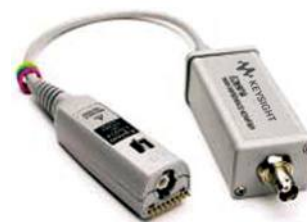
Гнездовые мини-пробники для тестирования печатных плат в горизонтальном и вертикальном исполнении облегчают подключение к тестируемой плате
