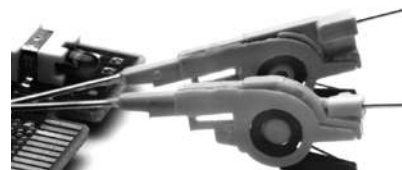
Малоразмерные зажимы для тестирования элементов поверхностного монтажа в корпусах PQFP и SOIC
