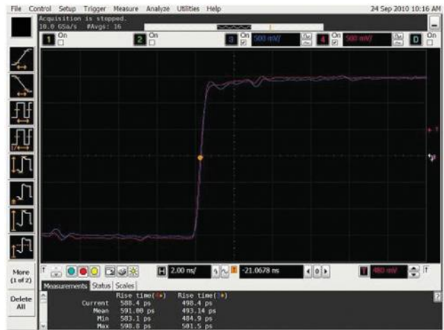
Переходная характеристика во временной области пробника N2796A (с осциллографом Keysight MSO9404A)
