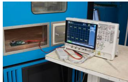
N7013A позволяет использовать дифференциальный пробник внутри климатической камеры при испытаниях на воздействие экстремальных температур
